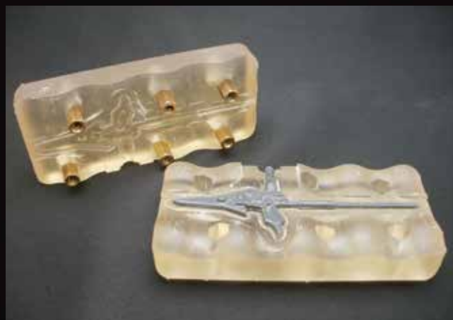
ハイテンプレジンで出力した射出成形の型
