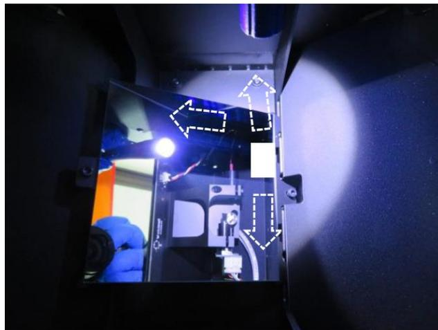
IPAで浸したPECPADで拭いても、筋汚れやふきだまり等で汚れが取り切れない場合、カメラやメガネ等の使い捨てレンズクリーナーを使用し、汚れや油膜等が落ちるまで清掃します。一度拭き取ったクリーナーの面は繰り返し使用しないでください。使用していない面に裏返したり、新たなレンズクリーナーを使用して、IPA・PECPADでの清掃と同じ方法で拭き取ります。
