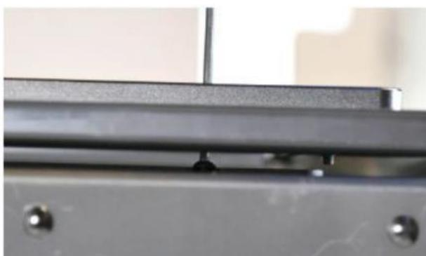
ニトリル手袋をはめます。2mmの六角レンチを使用し、Form 2本体を真上から見て、左側の六角ネジ2箇所を反時計回りに回して緩めます。
