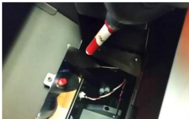
鏡面に埃がある場合、ブロワーを使って清掃します。
