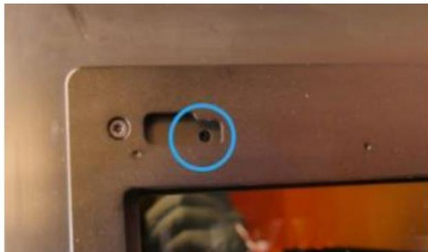
タンクキャリアを左側にスライドします。真上から見て、タンクキャリア左側の穴から光学ウィンドウ左側のねじが見えるまでスライドします。
