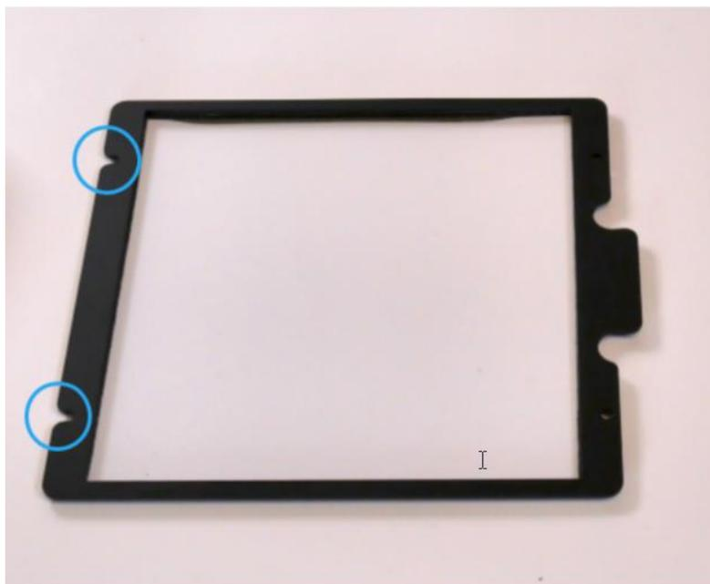
上写真を参照し、光学ウィンドウの穴が端までかけている部分（青丸部分）を本体真上から見て左側になるよう回転します。
