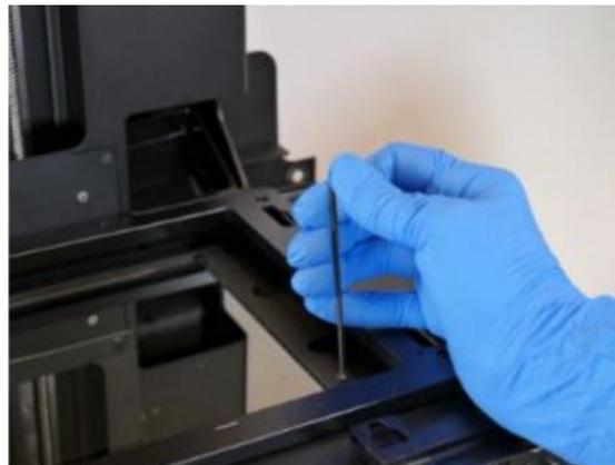
光学ウィンドウ右側2か所の穴に保管してある六角ねじを入れ、2mm角の六角ねじを使用し、時計回りに回して締め付けます。
