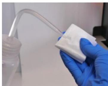
・油膜や汚れ、硬化した樹脂等によって光学ウィンドウが汚れている場合、拭き取ります。フィニッシュキット (Finishkit) に付属されているニトリル手袋をはめ、PECPADにIPAを染み込ませます。
