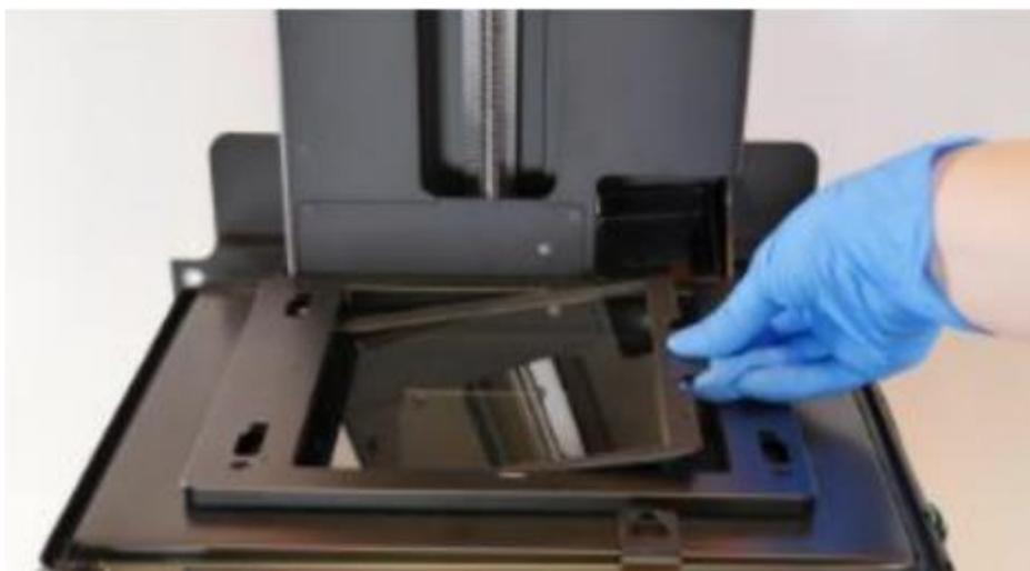
光学ウィンドウを左端下にスライドさせます。左端下にスライドする際、左側の六角ねじ2本が外れないように注意してください。左端下までスライドさせたら、右端をねじ挿入口に合わせるように下側におろします。
