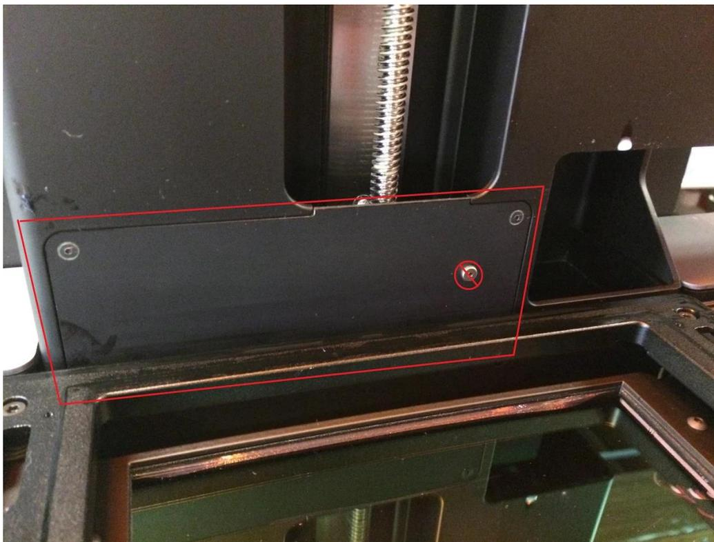
レベルセンス・ボードは、レジンタンク内のレジン（樹脂）の量を監視・調整しています。汚れが付くと、レジンタンク内のレジンの量が読み取りにくくなり、「Resin Sensor Error」というエラーがタッチパネルに表示され、造形ができなくなる場合があります。
