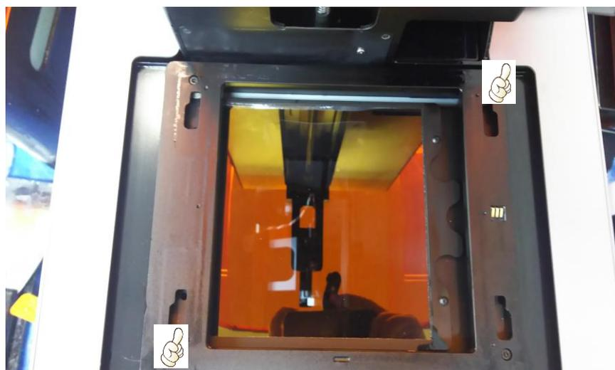
上写真のように右上・左下に親指を当て、垂直方向に数回押してください。続けて左上・右下に親指を当て、垂直方向に数回押し、タンクキャリア付近のレジンの塊や埃等を取り除きます。
