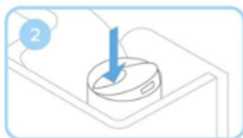
上図のようにレジンカートリッジ上部の通気用のキャップを押し開いてください。
