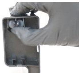
レジンカートリッジ下部のバイトバルブ（ゴム弁）を左写真のように親指と人差し指で押し広げるようにして、亀裂が入るようにしてください。亀裂が入らない場合、カッターで少し亀裂を入れてください。
