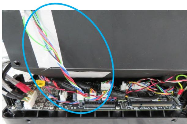
9. 上写真、青丸で囲っているヒーターボードケーブルの位置を確認します。
