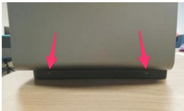
上写真を参照し、背面上左右と右側面下、左側面下に貼られている6か所の黒いシールを剥がします。黒いシールを剥がすと銀色の六角ボルトがあります。合計6個の六角ボルトをそれぞれ取り外します。取り外す際は2.5mm六角レンチを使用し、六角ボルトを反時計回りに回し取り外します。
