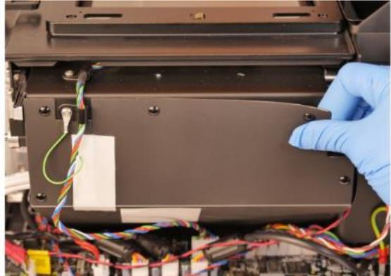
11. 上写真を参照し、本体正面より右側およびマザーボードの上にあるバッフルボードを取り外します。バッフルボードを外すには、上写真丸印のプラスチックリベット5本を外します。
