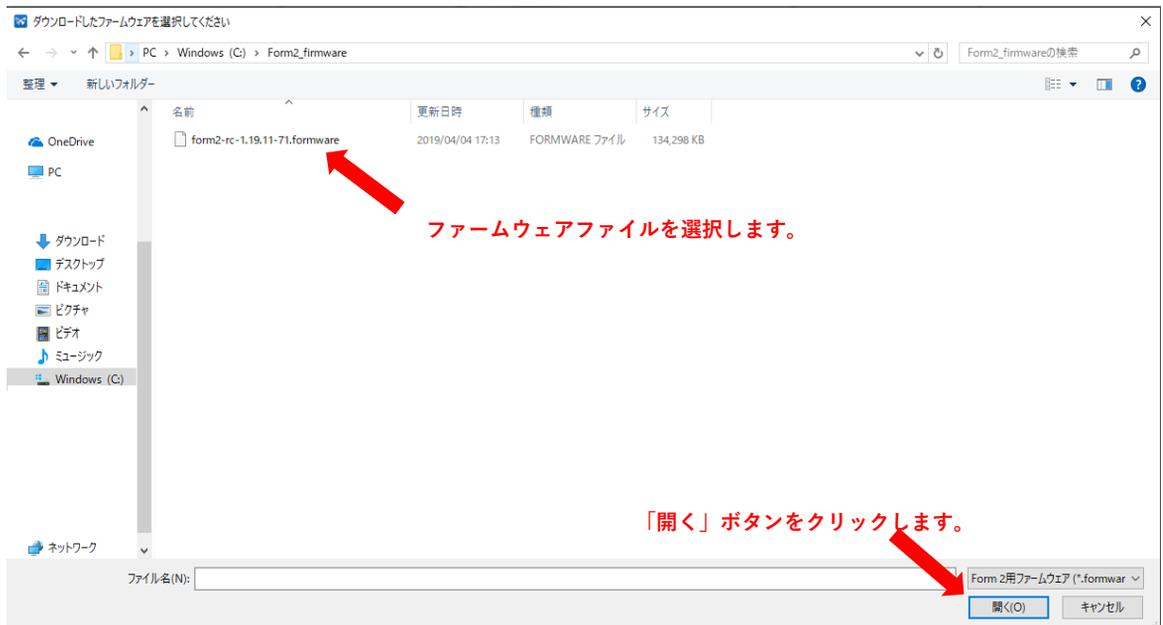
6. 「A. ファームウェアファイルのダウンロード」でダウンロードしたファームウェアファイル（拡張子\*.formware）を選択し、画面右下の「開く」ボタンをクリックします。
