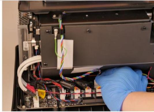
10. マザーボード側に取り付けられているヒーターボードケーブル（上写真参照）をマザーボードから取り外します。
