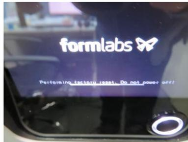
4. 約15-30秒ほど長押しすると、Formlabsのロゴ下に「Performing factory reset. Do not power off」メッセージが表示されます。表示されたら丸ボタンを離します。電源ケーブルは抜かないでください。
