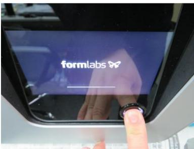
3. タッチスクリーンFormlabsのロゴが表示されたら、タッチスクリーン右下の丸ボタンを長押しします。
