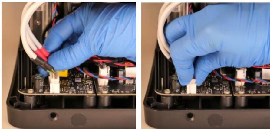
8. 取り外し後、約5分~10分程度放置します。同じ位置に黒と赤それぞれのシールで貼られているガルバノメーターケーブルをマザーボードへ1本ずつ取り付けます。取り付ける際はコネクタ部分を持ち、ケーブル内のハーネスが切れないように注意して取り付けます。
