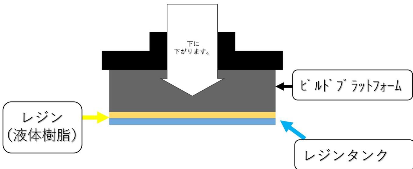
プリントの流れ②：レジンタンク下からレーザーを照射し硬化させます。
