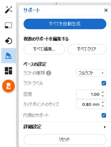
サポートを付けるには、PreFormよりサポート>“すべてを自動生成”を使用し自動的にサポートを生成するか、もしくはサポート>すべて編集を選択。手動でサポートを付けます。
