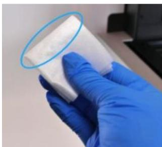
油膜や指紋、硬化した樹脂によって光学ウィンドウが汚れている場合、濡れ拭きをします。フィニッシュキット (Finishkit)に付属されているニトリル手袋をはめ、付属のPECPADにIPAを染み込ませます。
