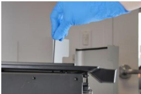
光学ウィンドウ左側の六角ねじを、2mm角の六角ねじを使用し、時計回りに回して締め付けます。
