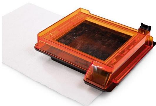
レジンタンク内のレジンを紙コップ等に移し、タンク内を空にします。レジンタンク付属の蓋をかぶせます。ペーパータオルを下に敷いて、レジンタンクを裏返し、透明のアクリル窓斜めからライトを当てて、表面に埃や指紋・汚れがついていないか確認します。
