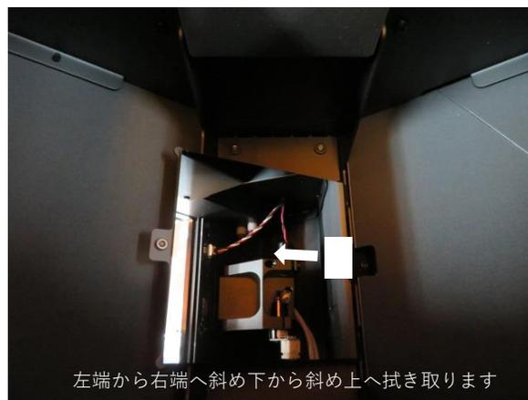
大型ミラーの左端から右端へ斜め下から斜め上へ1回あたり約20～30秒かけてゆっくりと拭き取ります。続けて右側に移動し同様に拭き取ります。拭き取る際は力を入れすぎないようにしてください。一度拭き取ったPECPADの面は繰り返し使用しないでください。PECPADを裏返したり、新たなPECPADを使用して、汚れや油膜等が落ちるまで清掃します。
