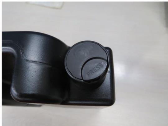
レジンカートリッジ上部の通気用のキャップが締まっていることを確認します。
