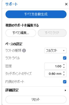
モデルの形状によっては、サポート自動生成コマンド「すべてを自動生成」でサポートを付けても、モデルの細部やビルドプラットフォーム平面に近い箇所においてサポートが作成されない場合があります。これらを「ミニマ」と言います。
