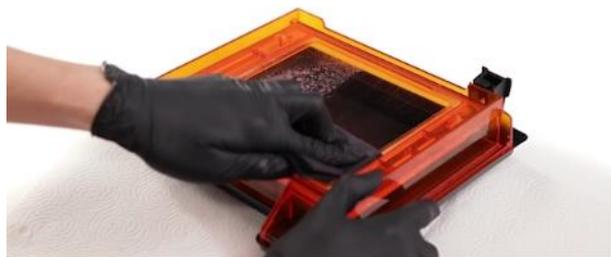
ニトリル製手袋をはめ、NOVUS No.1クリーナーと清潔なマイクロファイバー布を使って拭き取ります。NOVUS No.1を布に1-2回吹き付け、上から下に向かって大きなストロークで窓全体を拭きます。一回拭くごとに、布を折り畳み、絶えずきれいな面で拭くようにします。
