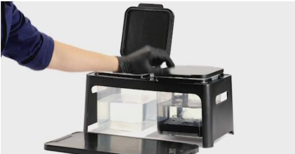
造形物を合計で20分間IPA（イソプロピルアルコール）に漬けることにより、アルコール分が浸み込み、粘り気をなくしていきます。小さな造形物は、サイズに応じて、浸す時間を短くしてください。
