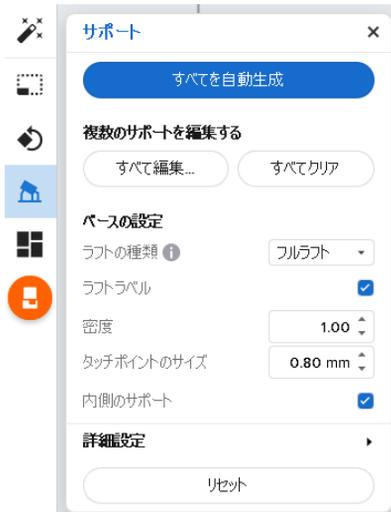
サポートを付けるには、PreFormよりサポート>“すべてを自動生成”を使用し自動的にサポートを生成するか、もしくはサポート>すべて編集を選択。手動でサポートを付けます。
