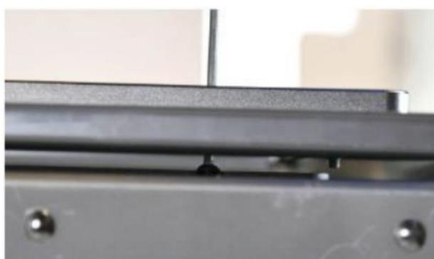
ニトリル手袋をはめます。2mmの六角レンチを使用し、Form 2本体を真上から見て、左側の六角ネジ2箇所を反時計回りに1回転～1回転半回して緩めます。
