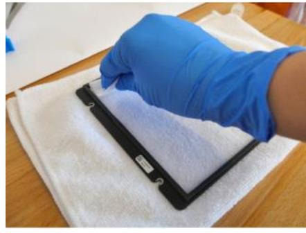
光学ウィンドウの左端上から下に1回あたり約20～30秒かけてゆっくりと拭き取ります。続けて右側に移動し同様に拭き取ります。拭き取る際は力を入れすぎないようにしてください。一度拭き取ったPECPADの面は繰り返し使用しないでください。PECPADを裏返したり、新たなPECPADを使用して、汚れや油膜等が落ちるまで清掃します。
