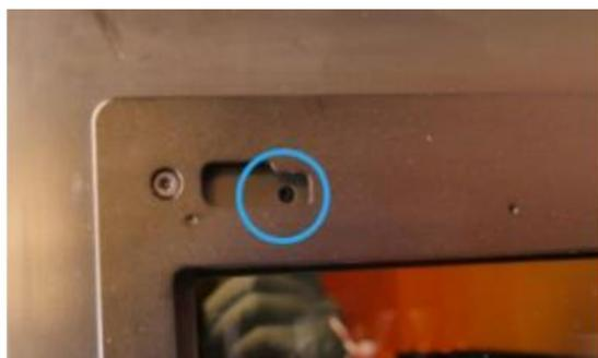
タンクキャリアを左側にスライドします。真上から見て、タンクキャリア左側の穴から光学ウィンドウ左側のねじが見えるまでスライドします。
