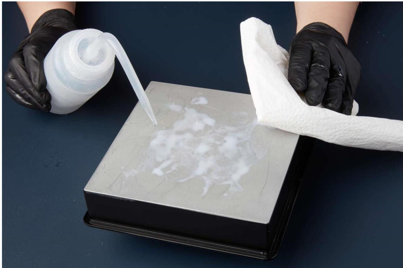
パーツをビルドプラットフォームから取り外し後、IPAとペーパータオルを使用してレジンを取り除きます。レジンの欠片等がこびりついている場合、Finishkitに付属のスクレーパーや取り外し用ツールを使用して、取り除きます。
