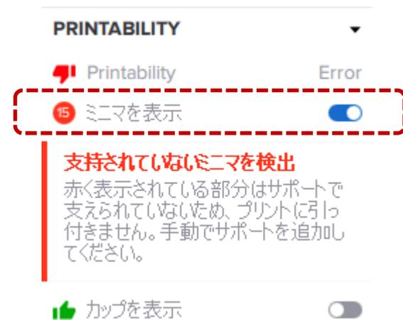
「ミニマ」が検出された箇所をハイライトするには、画面右側の「プリント適正」欄内、「ミニマを表示」を「ON (スイッチを右にスライド)」にします。
