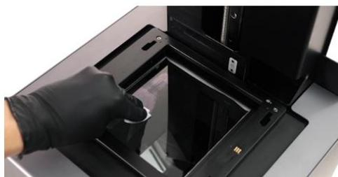
IPAで浸したPECPADで拭いても、筋汚れやふきだまり等で汚れが取り切れない場合、カメラやメガネ等の使い捨てレンズクリーナーを使用し、汚れや油膜等が落ちるまで清掃します。一度拭き取ったクリーナーの面は繰り返し使用しないでください。使用していない面に裏返したり、新たなレンズクリーナーを使用して、IPA・PECPADでの清掃と同じ方法で拭き取ります。
