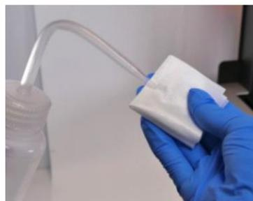
・油膜や指紋、硬化した樹脂によって光学ウィンドウが汚れている場合、濡れ拭きをします。フィニッシュキット (Finishkit)に付属されているニトリル手袋をはめ、付属のPECPADにIPAを染み込ませます。
