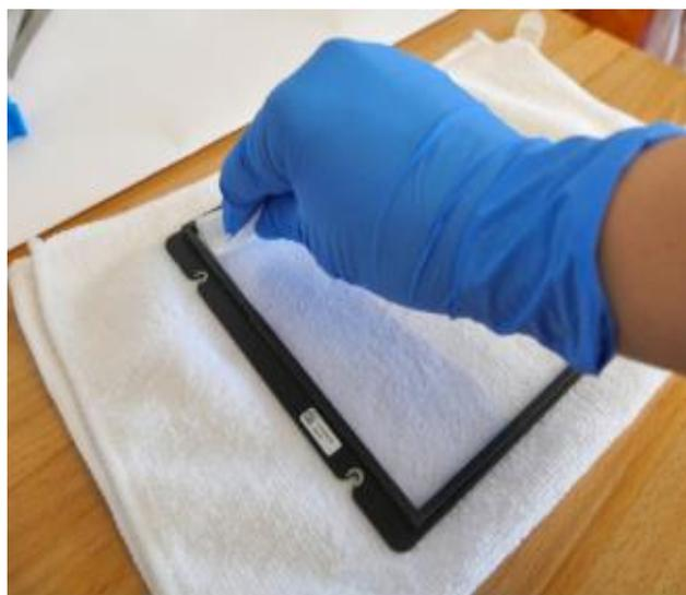
IPAで浸したPECPADで拭いても、筋汚れやふきだまり等で汚れが取り切れない場合、カメラやメガネ等の使い捨てレンズクリーナーを使用し、汚れや油膜等が落ちるまで清掃します。一度拭き取ったクリーナーの面は繰り返し使用しないでください。使用していない面に裏返したり、新たなレンズクリーナーを使用して、IPA・PECPADでの清掃と同じ方法で拭き取ります。
