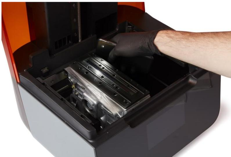
LPU上面中央に装着されている光学窓が汚れていないか点検します。点検する際は、ペンライト等の照明器具を使用して光学窓を様々な方向から照らして汚れがないか確認してください。汚れている場合は清掃します。
