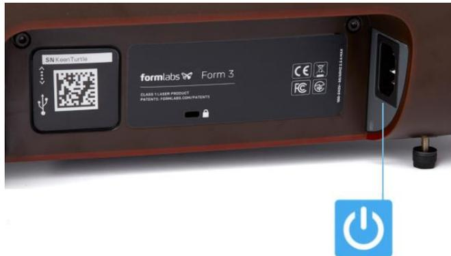
点検・清掃が終わり、汚れ等がついていないことを確認したら、電源ケーブルをプリンタとコンセントに接続します。プリンタは初期化します。LPUが元の定位置に戻り、キャリブレーション (Calibration)を実施します。キャリブレーションに数時間続いている場合は電源ケーブルを抜き、入れ直します。
