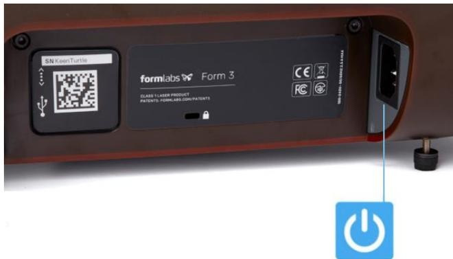
点検・清掃が終わり、汚れ等がついていないことを確認したら、電源ケーブルをプリンターとコンセントに接続します。プリンタは初期化します。LPUが元の定位置に戻り、キャリブレーション (Calibration)を実施します。キャリブレーションに数時間続いている場合は電源ケーブルを抜き、入れ直します。
