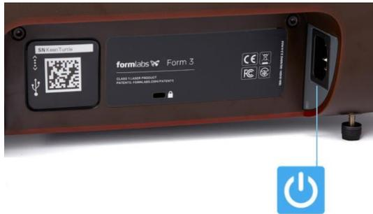
1. 電源ケーブルをプリンターとコンセントに接続します。プリンターは初期化します。LPUが元の定位置に戻り、キャリブレーション (Calibration)実施します。
