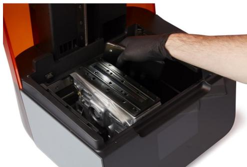
ローラーホルダーを固定するねじを取り付ける前にペンライト等の照明器具を使用して、光学窓を様々な方向から照らして、汚れが油膜等がないか確認します。
