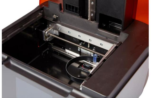
X軸リードスクリュー、Z軸リードスクリューに異物等が付着していないか点検します。
