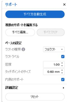
モデルの形状によっては、サポート自動生成コマンド「すべてを自動生成」でサポートを付けても、モデルの細部やビルドプラットフォームフォーム平面に近い箇所においてサポートが作成されない場合があります。これらを「ミニマ」と言います。
