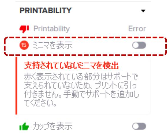
「ミニマ」が検出された場合、PreForm デフォルトの設定では「ミニマ」の箇所はハイライトされません。は表示されません。画面右側の「プリント適正」欄内、「ミニマを表示」の左側に赤丸でミニマの数が表示されるだけです。
