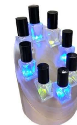
光るマニキュアボトルスタンド (ボトルの荷重でOnして点灯)
